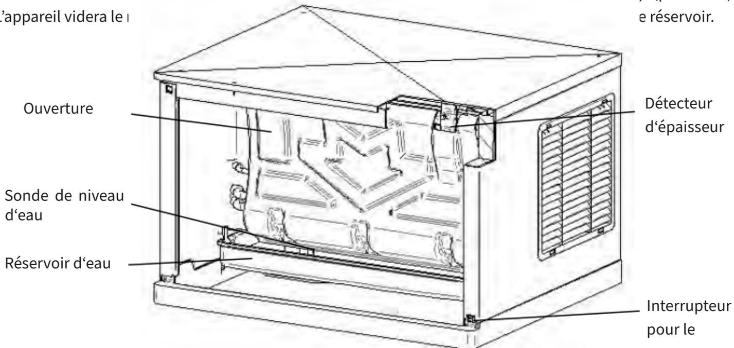
5. Laissez la solution circuler dans le circuit d'eau pendant 30 à 40 minutes, puis mettez le sélecteur de fonctionnement (glace-nettoyage) sur la position OFF.
