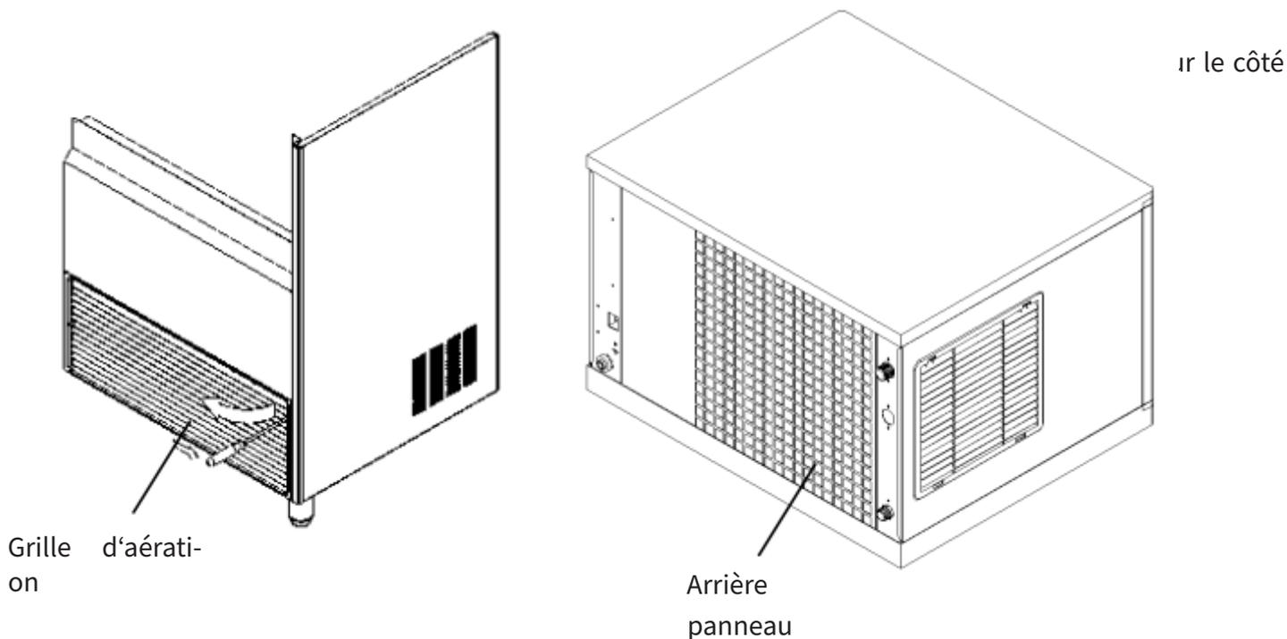
3. Nettoyez le condenseur à l'aide d'un aspirateur, d'une brosse souple ou d'une légère pression d'air. Nettoyez de bas en haut, et non d'un côté à l'autre. Il faut faire attention à ne pas plier les ailes du condenseur.)
